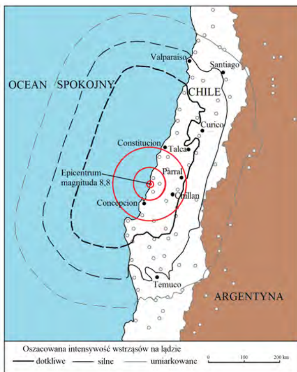
Ryc. 2.2. Zasięg wstrząsów i drgań podczas trzęsienia ziemi, przykład z Chile 2010
