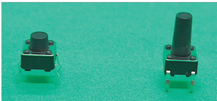
Rysunek 3.1. Przyciski normalnie zamknięty (po lewej) i normalnie otwarty (po prawej)
