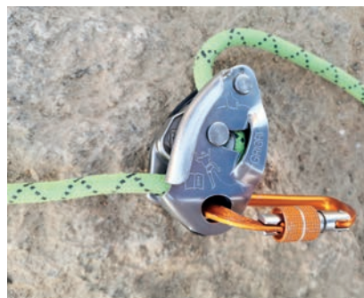
Układ liny w zamkniętym przyrządzie
