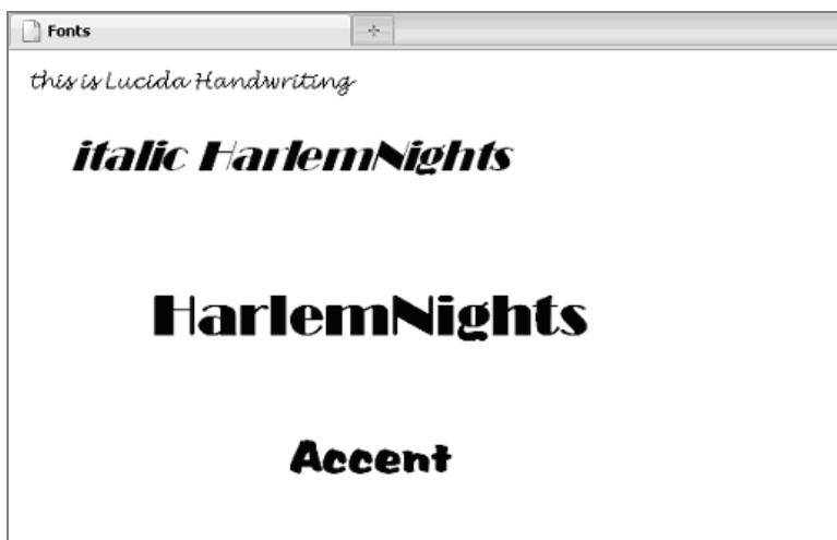
Rysunek 5.9. Tekst z użyciem różnych czcionek wyświetlony na elemencie canvas z użyciem metod font() i fillText()
