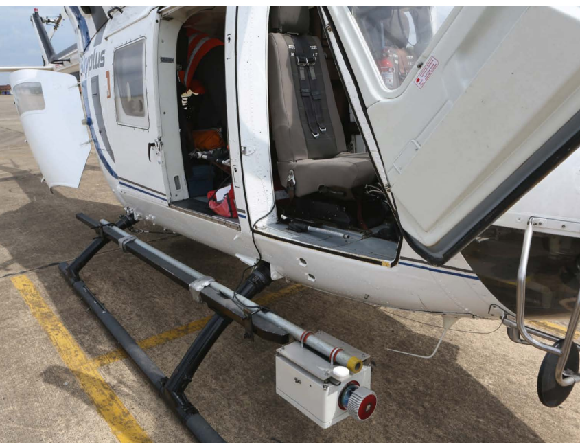
Lidar, czyli skaner laserowy, zamocowany na płozie helikoptera. To on umożliwił badaczom zajrzenie pod powierzchnię gruntu.
