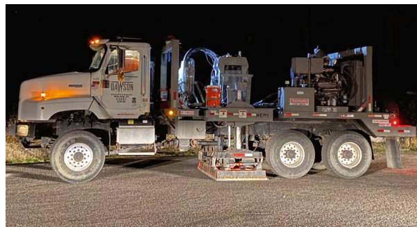
Wibrator do wzbudzania fal sejsmicznych to ciężki pojazd terenowy ze stalową płytą opuszczaną na grunt i wprawianą w silne drgania
