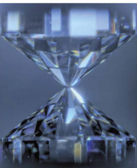
Komorę diamentową, czyli dwa diamenty skierowane ku sobie wąskimi końcami.
