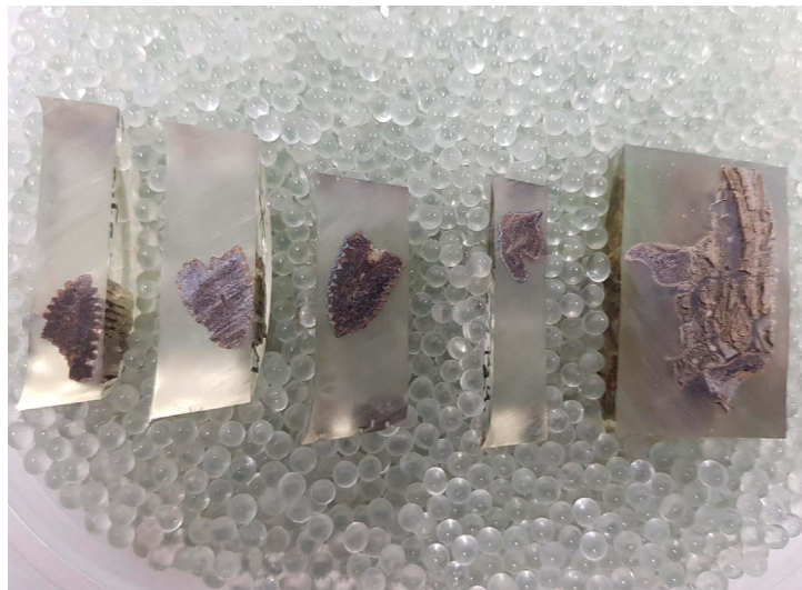
Próbki z fragmentami rybich kości przygotowane do prześwietlenia promieniami rentgenowskimi
