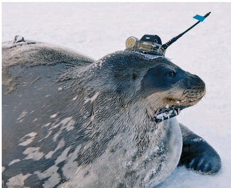
Foka Weddella z zainstalowaną aparaturą do pomiaru temperatury, zasolenia i głębokości wody
