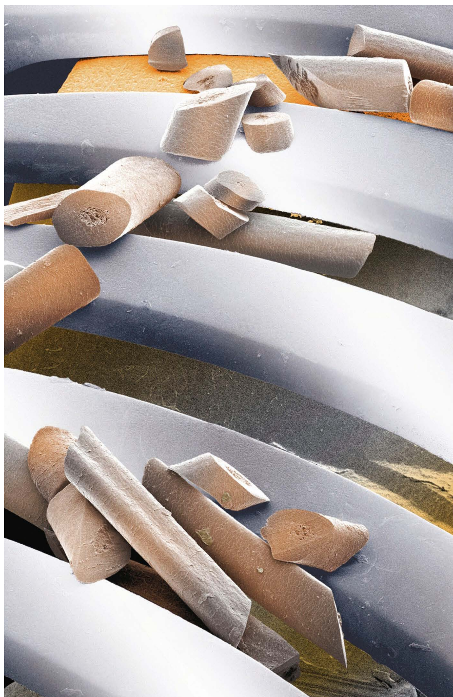
Zbliżenie na maszynkę elektryczną, która najwidoczniej dopiero została użyta do ścięcia zarostu. Po przyciśnięciu żyłeczki do skóry włosy (brązowe) przechodzą przez szczeliny (srebrne) i są przecinane przez obracające się ostrza wewnątrz urządzenia.
