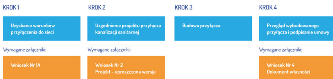
Rysunek 1. Przykładowy schemat uproszczonej procedury podłączenia przyłącza do istniejącej sieci kanalizacyjnej we Wrocławiu
