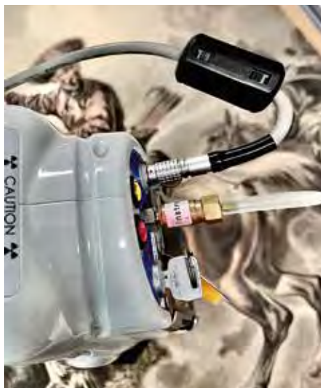
Spektrometr XRF podczas nieinwazyjnych pomiarów.
