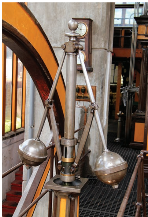
Zdj. 1. Odśrodkowy regulator obrotów zastosowany w silniku parowym
