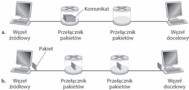
Rysunek 1.27. Transport komunikatu między węzłami: (a) — bez zastosowania segmentacji; (b) — z wykorzystaniem segmentacji
