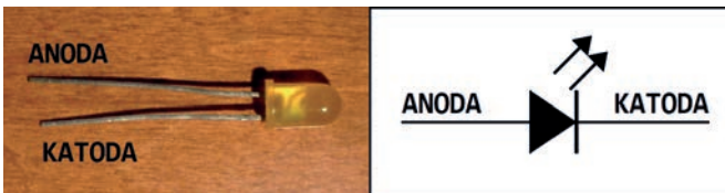
Rysunek 2.23. Oznaczenie nóżek diody LED rzeczywistego komponentu (z lewej) i symbolu stosowanego w schematach (z prawej)
