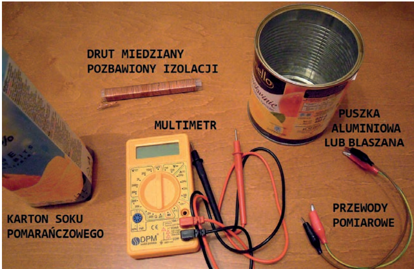
Rysunek 2.1. Zestaw do budowy i pomiaru ogniwa galwanicznego
