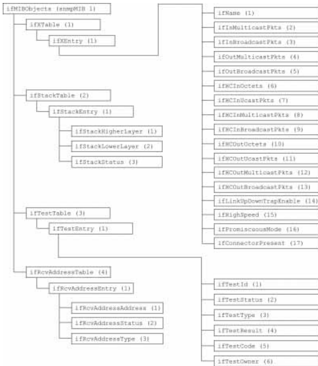
Rysunek 13.4. Dodatki do grupy interfaces wprowadzone w SNMPv2
