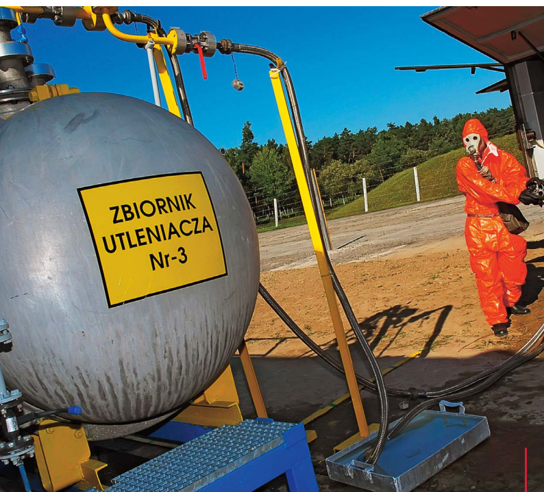
Fragment instalacji do utylizacji paliwa raketowego AK-20K
