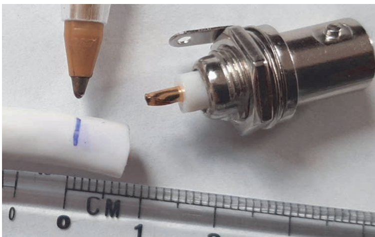
Rysunek 1.1. Odizolować przewód trzeba tylko na takiej długości, jaka jest niezbędna do wykonania połączenia
