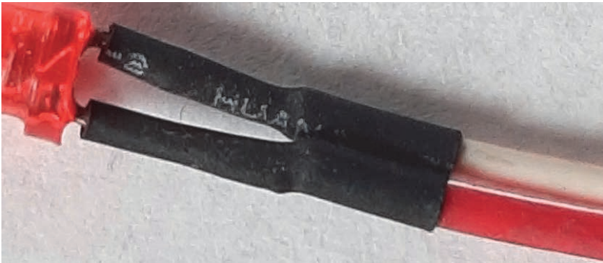
Rysunek 1.14. Połączenie zaizolowane z wykorzystaniem koszulek termokurczliwych
