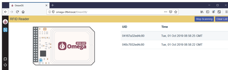
Rysunek 12.1. Odczyt identyfikatora UID kart lub naklejek NFC w narzędziu RFID Reader
