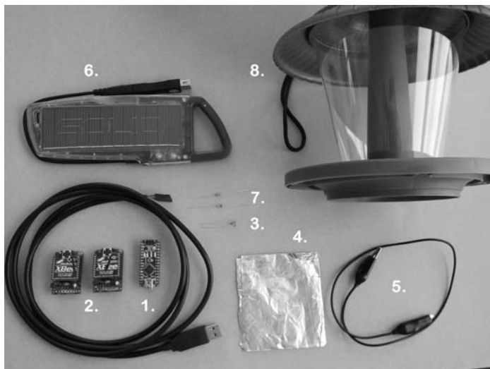
Rysunek 5.2. Części systemu ćwierkającego karmnika dla ptaków
