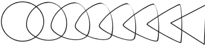
Rysunek 3.33. Pomiędzy ścieżką o kształcie okręgu a ścieżką o kształcie trójkąta zostało utworzonych sześć ścieżek będących krokami pośrednimi interpolacji
