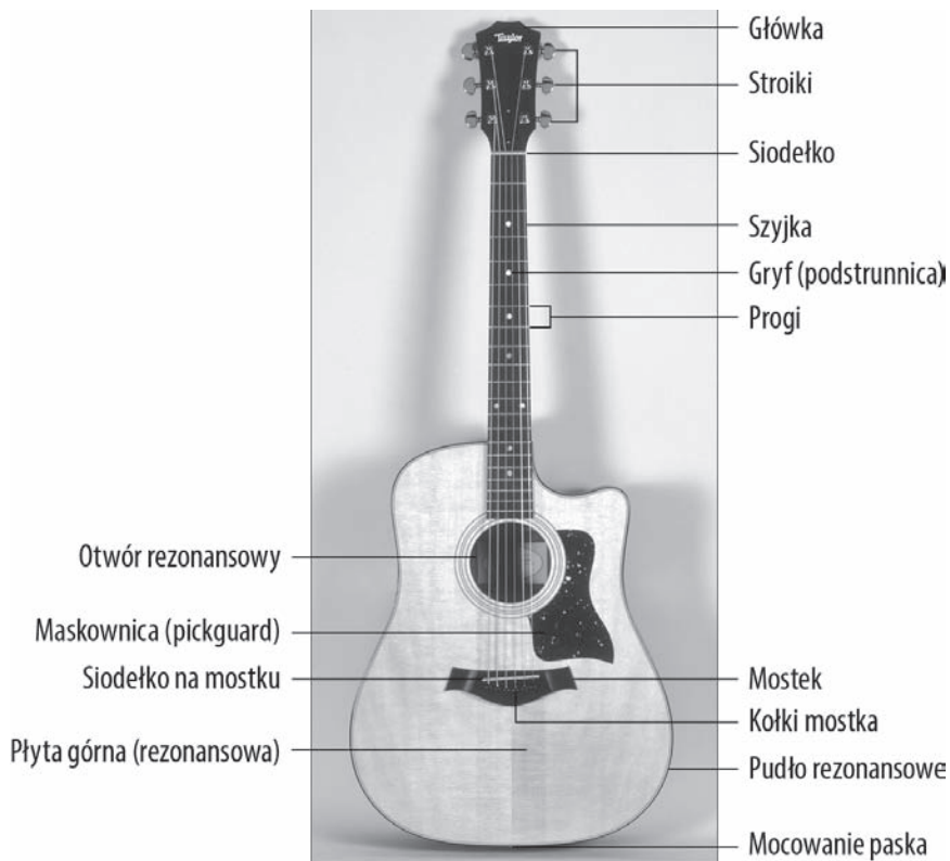
Rysunek 1.1. Typowa gitara akustyczna z oznaczonymi najważniejszymi częściami
