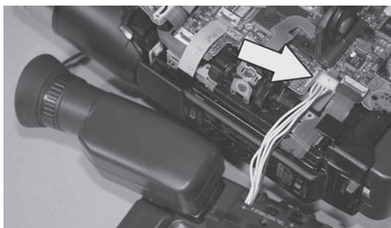
RYСУNEK 10.2. Określenie miejsca podłączenia wizjera
