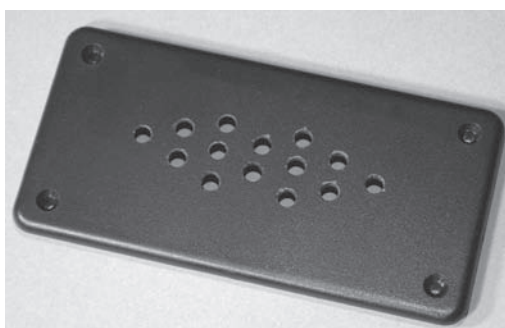
RYСУNEK 10.28. Wywiercone otwory na diody LED
