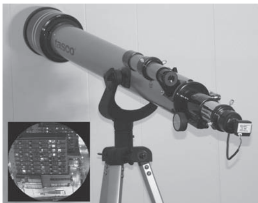
RYСУNEK 10.23. Kamera noktowizyjna bardzo dalekiego zasięgu
