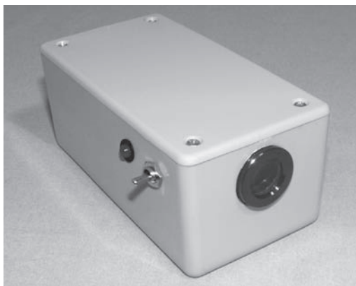
RYСУNEK 10.21. Gotowy iluminator laserowy dużej mocy
