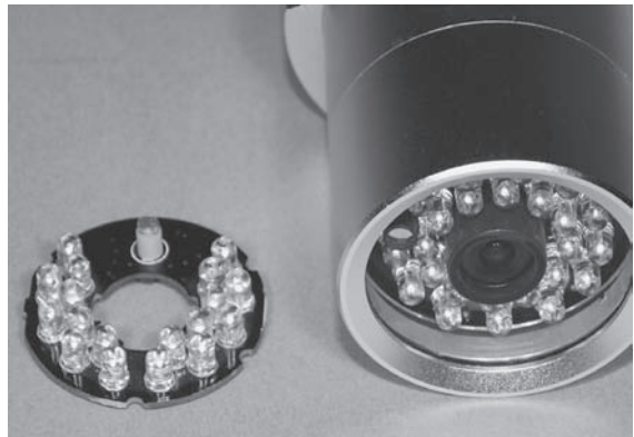
RYСУNEK 10.13. Alternatywne rozwiązanie dla pojedynczej diody LED
