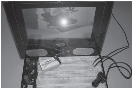
RYСУNEK 10.9. Testowanie reakcji kamery na promieniowanie podczerwone
