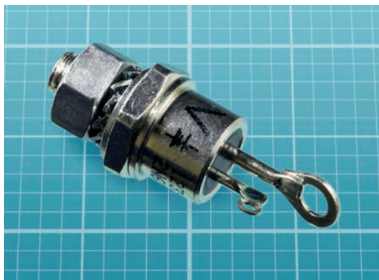
Rysunek 1.5. SCR w obudowie śrubowej o znamionowym powtarzalnym napięciu w stanie wyłączenia wynoszącym 50 V i prądzie nie większym niż 25 A RMS
