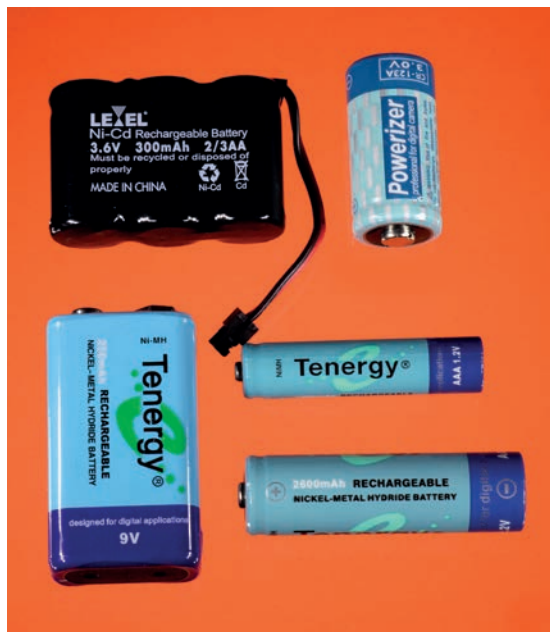
Rysunek 2.9. U góry po lewej: zestaw ogniwi NiCd stosowany w telefonach bezprzewodowych; u góry po prawej: akumulator litowy do aparatu fotograficznego; u dołu: trzy akumulatory NiMH będące zamiennikami popularnych baterii alkalicznych
