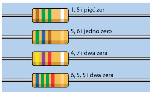
Rysunek 1.40. Cztery przykładowe rezystory oznaczone kodem paskowym
