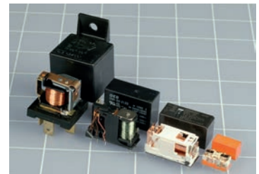
Rysunek 2.57. Cztery przełączniki różnego typu zasilane napięciem 12 V, pokazane w swojej obudowie i bez niej. Przełącznik stosowany w samochodach (skrajnie lewy) jest najprostszy i najłatwiejszy do zrozumienia, ponieważ przy jego projektowaniu rozmiar obudowy nie miał szczególnego znaczenia. Mniejsze przełączniki są zaprojektowane bardziej pomysłowo, ich konstrukcja jest bardziej złożona i trudniejsza do rozpracowania. Mniejsze przełączniki są przeważnie przeznaczone do przełączania mniejszych prądów niż ich większe odpowiedniki
