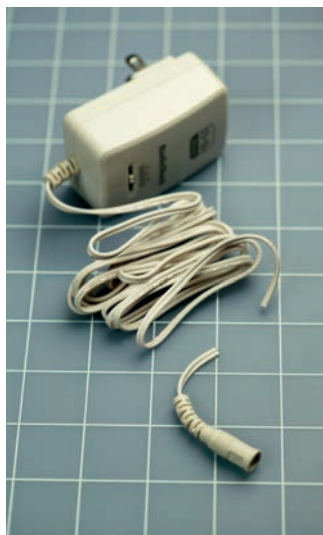
Rysunek 2.49. Przygotowanie zasilacza uniwersalnego. Zaczynij od odcięcia wtyczki dostarczającej niskie napięcie i wyrzuć ją do kosza
