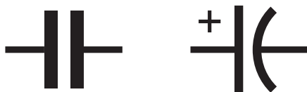
Rysunek 2.69. Ogólny symbol kondensatora znajduje się po lewej stronie. Wersja po prawej stronie wskazuje na kondensator z polaryzacją, którego lewa okładzina powinna być „bardziej pozytywna” niż prawa. Znak plus jest często pomijany
