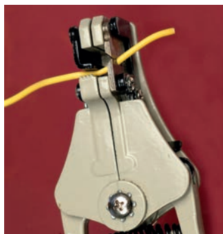
Rysunek 2.19. Kiedy ściśniesz rączki narzędzia do automatycznego zdejmowania izolacji, szczęki po lewej stronie chwycą przewód, a ostre rowki po prawej wbiją się w izolację. Kiedy ściśniesz mocniej, obie szczęki oddalą się od siebie, zdejmując izolację z przewodu
