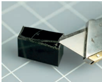
Rysunek 2.53. Wsuń ostrze noża, aby odciąć górę obudowy, a następnie powtórz tę procedurę dla pozostałych ścian obudowy
