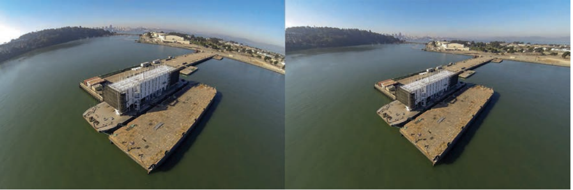
RYSUNEK 4.19. Zrobione z lotu zdjęcie tajemniczej barki Google w Alameda w Kalifornii, z efektem dystorsji beczkowej i po usunięciu tego efektu
