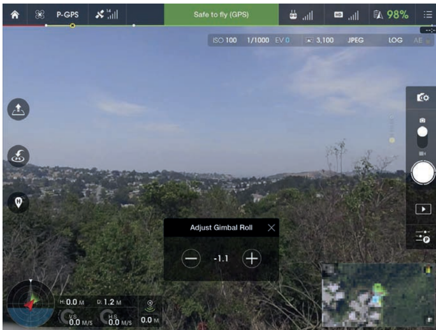
RYSUNEK 4.8. Ręczne ustawianie pozycji gimbała na osi roll przez aplikację DJI GO podczas lotu DJI Phantom
