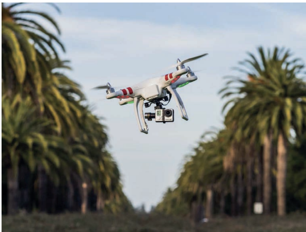
RYСУNEK 4.3. Dwuosiowy gimbal Zenmuse H3-2D utrzymuje kamerę GoPro w poziomie podczas lotu drona DJI Phantom 2
