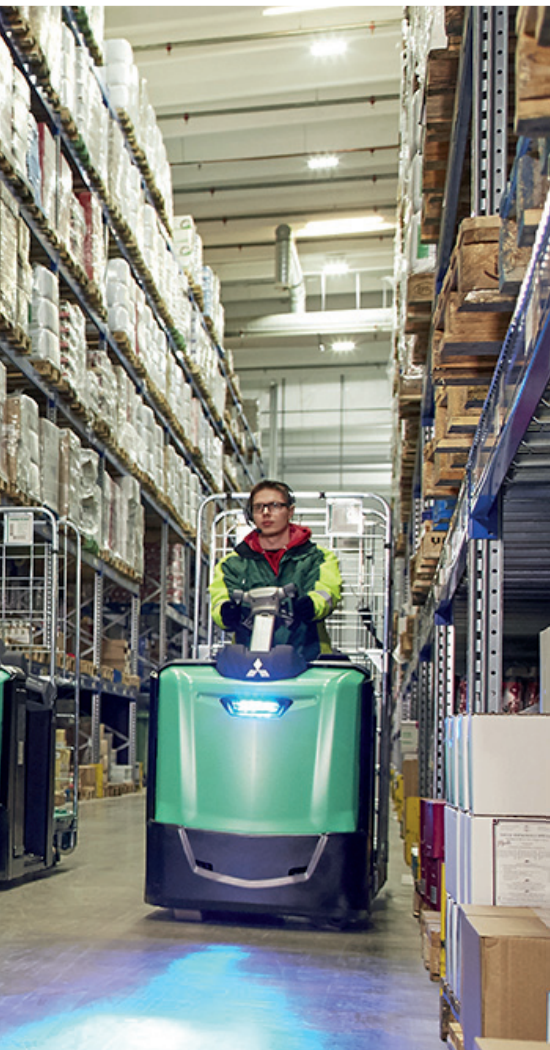
Fot. 3. Przechodnia kabina oferuje o 18% większą przestrzeń roboczą niż standardowa, co przekłada się na 20% większą produktywność (fot. https://www.a1-mitsubishi.co.uk/en/eu/mitsubishi-velia-es-opb10-20ne-series-low-level-order-pickers ; dostęp: 12.07.2018).
