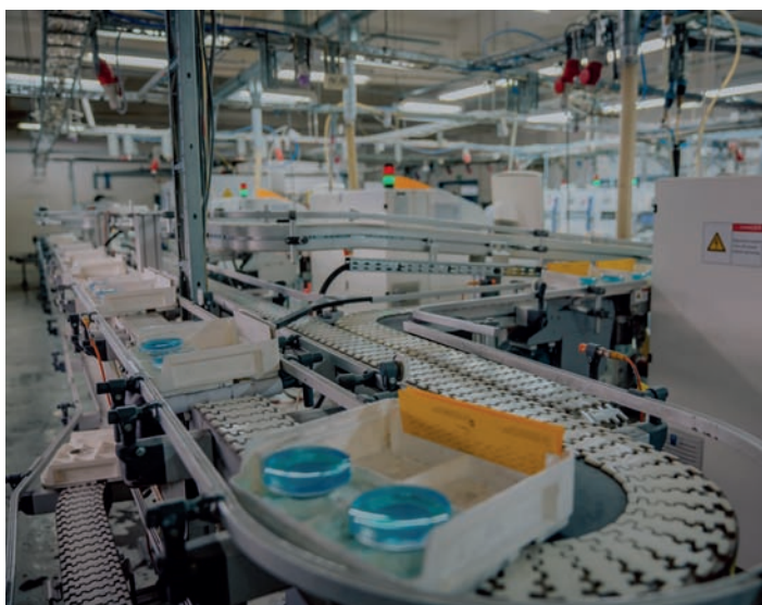
Fot. 3. Transport między blokowaniem, a frezowaniem (fot. JZO S.A.).
