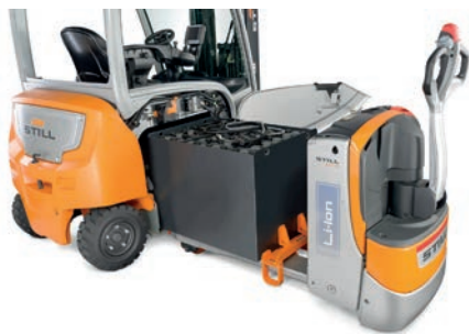
Fot. 2. RX 20 umożliwia również łatwą i szybką boczną wymianę akumulatora za pomocą wózka paletowego. Źródło: STILL GmbH, https://www.still.de/en-DE/company/news-press/detail/rx-20-a-powerhouse-machine.html (dostęp: 12.02.2018).
