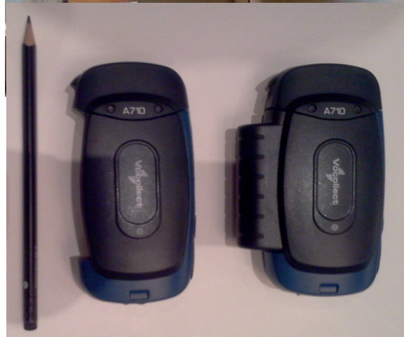
Fot. 5. Skaner Talkman A710 (z baterią i bez) jest krótszy od ołówka (fot. Iwo Nowak).
