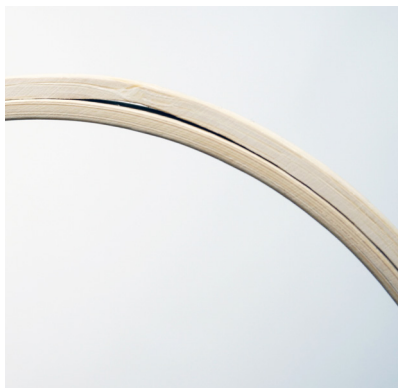
Przykład tamborka bambusowego, w którym obręcze nie stykają się idealnie.
