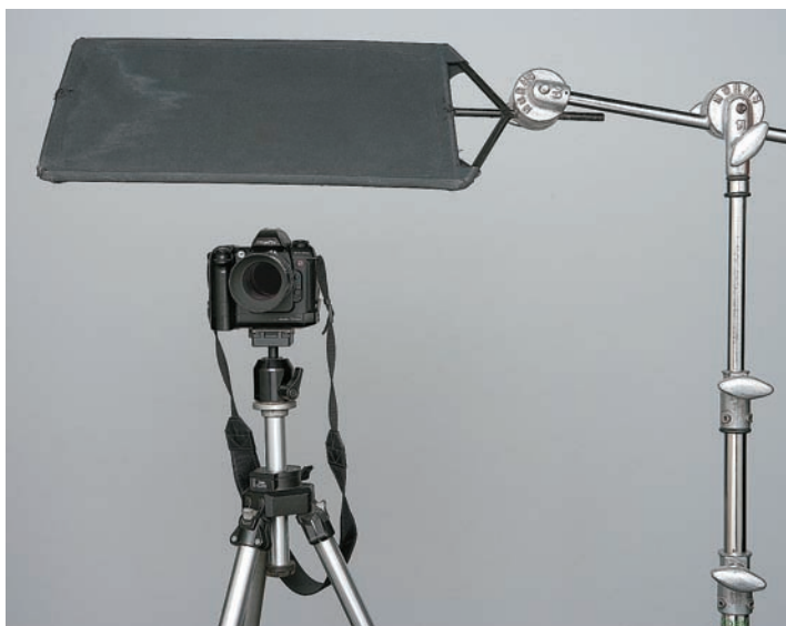
Rys. 3.3. Ten ekran ustawiony został w taki sposób, by osłaniał aparat przed światłem padającym z góry na obiektyw i stanowiącym potencjalne źródło niepożądanych odbłasków
