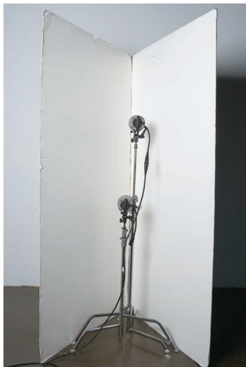
Rys. 3.2. Dwie nieosłonięte lampy błyskowe, skierowane w głąb ekranów ułożonych w kształt litery „V”, stanowią źródło silnie rozproszonego światła
