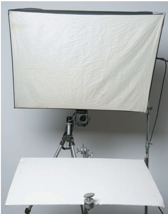
Rys. 3.10. Wygląd zestawu oświetleniowego z punktu widzenia modelki: softboks znajduje się na wprost twarzy, a nieco poniżej, prawie poziomo, umieszczono biały ekran odbijający światło ku górze
