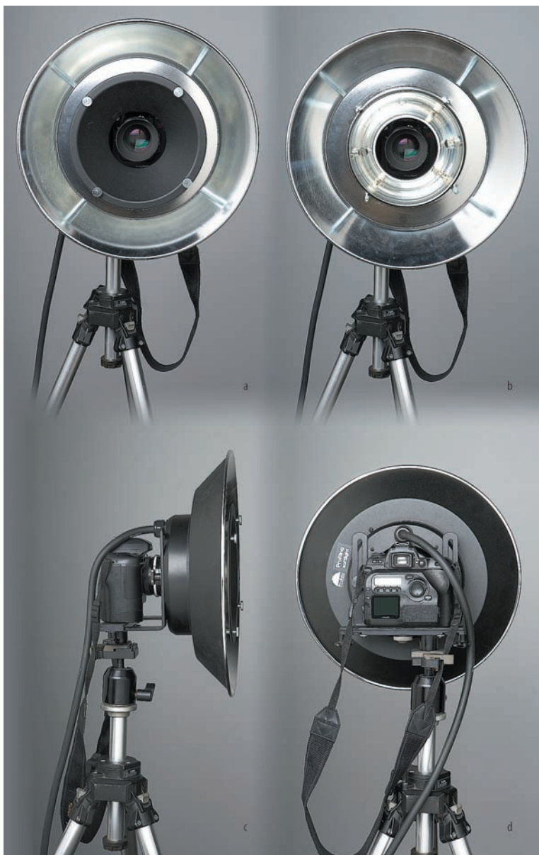
Rys. 3.6. (a) Lampa pierścieniowa z maską, która osłania jej wewnętrzną konstrukcję (pośrodku reflektora widoczna jest przednia soczewka obiektywu); (b) lampa po zdjęciu maski (na zdjęciu widoczna jest okrągła, szklana rurka żarówki); (c) widok z boku wraz z aparatem zamocowanym na statywie; (d) widok z tyłu
