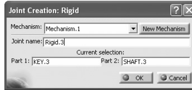
RYSUNEK 10.18. Okno dialogowe Joint Creation: Rigid (tworzenie więzu sztywnego)
