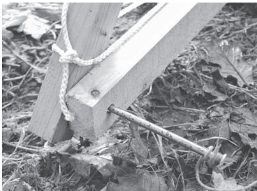
RYСУNEK 2.14. Mechanizm spustowy
